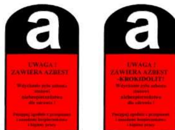
Oznakowanie wyrobów i odpadów zawierających azbest
